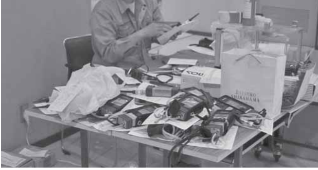
新コスモス電機(株)による検知器点検
